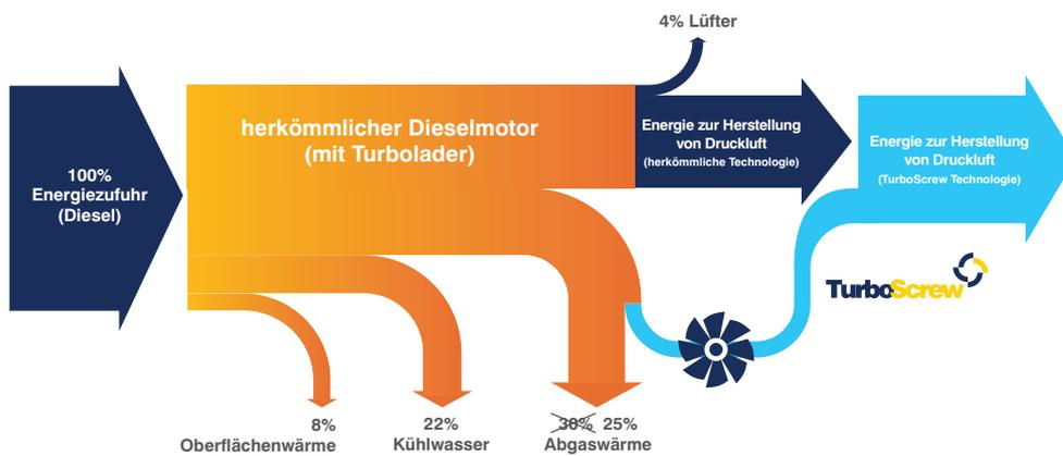
Durch den Einsatz der TurboScrew Technologie liefert der Motor ca. 14% mehr Energie an den Kompressor als bei herkömmlichen Technologien.
