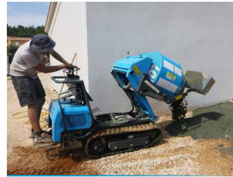
Concrete mixer, 180 l mixed capacity Betonmischer, mischkapazität 180 l
